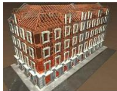
Estrutura em Gaiola
